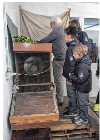
Christina Armato setzt eine selbstgebaute Maschine ein, mit der die Blätter von den Oliven durch ein Gebläse getrennt werden.
